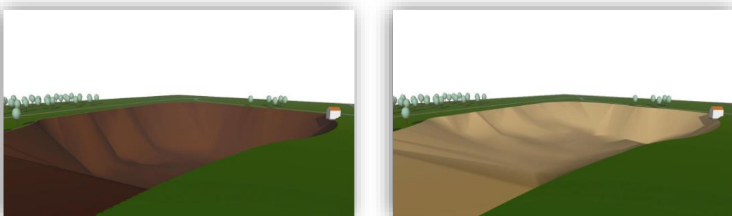
Abb. 3: Darstellung des Weiherbeckens ohne Schlamm (links) und mit Schlamm (rechts). Die Darstellungen sind 10-fach überhöht (aus Stöckli 2007).
